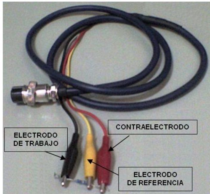
Figura 3: Sonda de conexión potenciostato.
